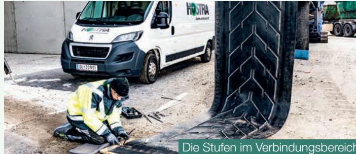
Die Stufen im Verbindungsbereich wurden mit einer Seilwinde abgezogen.
